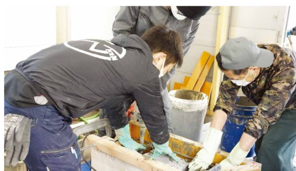
図14 学生参加によるコンクリートベンチの制作
