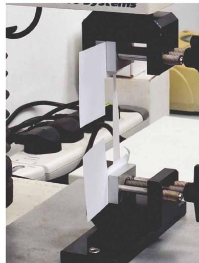
図7 食品パッケージの引張試験の様子
