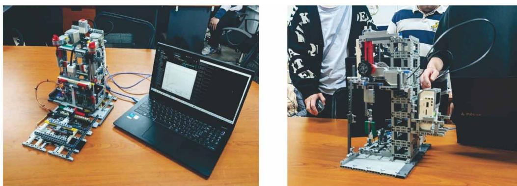
図8 (左) LEGOにより作成した引張試験の試作機 (右) 引きはがし試験機の試作機
