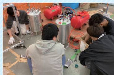
▲ 試験設備の組み立て
