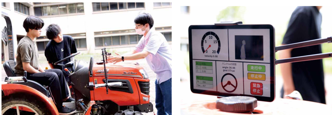
図9 トラクター自動制御実習。左はタブレット端末を設置している様子。右は運転者への表示画面、位置、速度、障害物等が表示されている。
