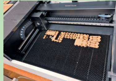
▲レーザー加工機を使用して部品を作製
