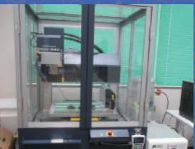
木材やアルミなどの素材を切削加工する機器です。デジタルデータに基づき、いろいろな素材を削って造形することができます。
