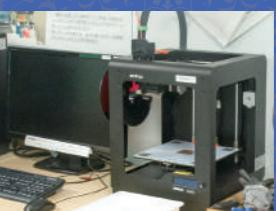
3次元CADなどの3Dデータをもとに、熱した樹脂素材を積層していく過程を繰り返してデータと同形の立体物を成型する機器です。デジタルデータを立体物として出力（造形）できることが特徴です。
