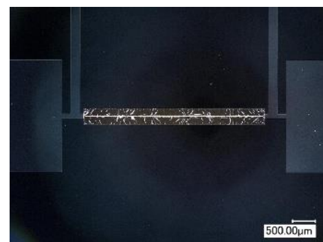
厚さ 100nm 以下の自立超薄膜サンプル
