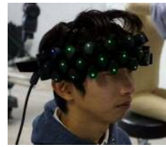
モバイル型 前頭皮質活動計測装置
