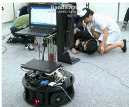
RoboCup Japan Open 2015 脳波を用いたナースコールロボット (九工大 若松 夏目研)
