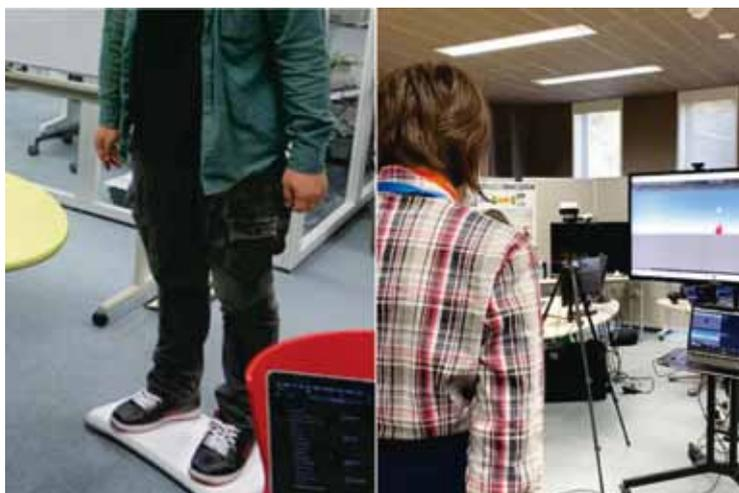
図2-5 （左）Wiiバランスボードを用いた足圧中心情報の取得 （右）リハビリゲーム応用
