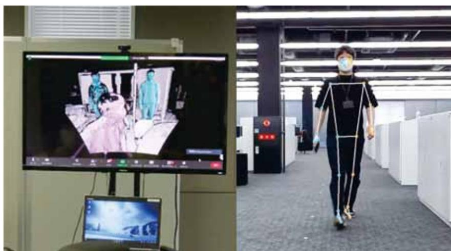
図2-4 （左）深度センサを用いた姿勢情報の取得 （右）動画像にMediaPipeを適用
