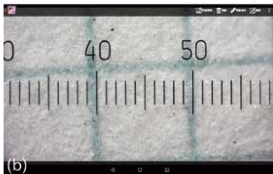
図4：(a) 顕微鏡で見たニュートン環を撮影した静止画と (b) その同一縮尺のスケール。学生は画面上の写真にもものさしを当て、実測値をスケール長に変換してニュートン環の半径を測定して解析する。
