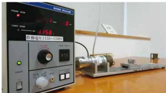
図6. 動画では放射線の遮蔽効果を測定しているようすが視聴できる。学生は動画中の数値を読み取り、データとしてプロットし、グラフにして解析を行う。
