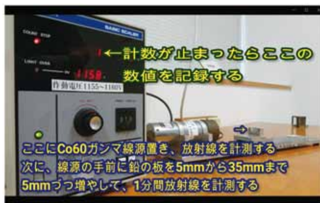
図9. 放射線の測定用動画の一例 動画の補足説明をテロップ型式で挿入し、動画を見るだけで実験の様子を把握して測定が出来るよう工夫した。
