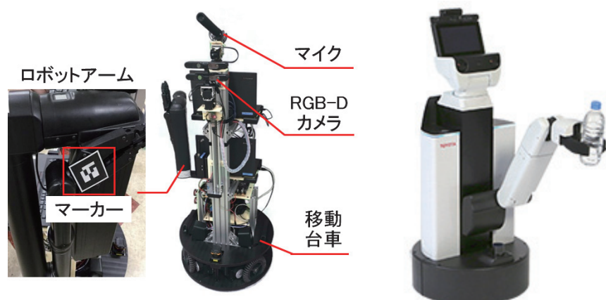
図2：@ホームロボットのハードウェア 左：Eix@、右：TOYOTA HSR
