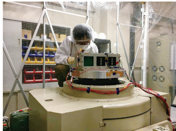
図8 BIRDS-Iの振動試験の様子
