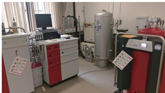
写真3 SQUID 磁束計のある実験室
