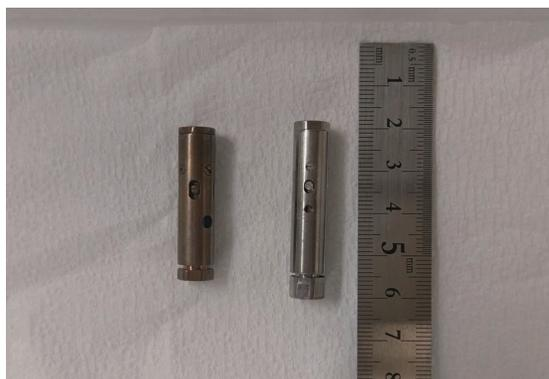
写真2 mDAC (CuBe製(左), Ti合金製(右))
