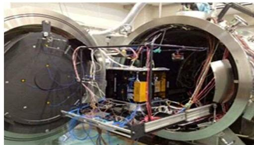
ダミー衛星を用いた熱真空試験実習
